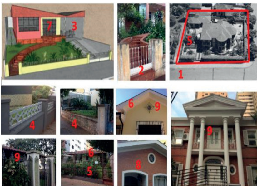
Figura 4 – Exemplos de elementos que definem o caráter histórico de edificações residenciais, por escala: LOTE (1) implantação, (2) acessos, (3) garagem, (4) muro-cerca, (5) jardim-pomar, EDIFÍCIO (6) volume/forma, telhado, recortes, (7) aberturas/ acessos, (8) materiais, (9) ornamentos. Fotos da autora.
